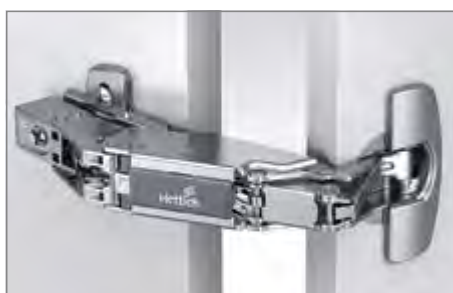
Sensys 165°, петля для открывания дверей без выступа
