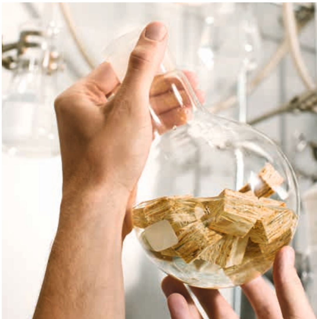
Древесина в лаборатории: при перфораторном методе содержание формальдегида в древесных материалах измеряется путем экстрагирования этого вещества из образцов плит толуолом и его последующего фотометрического определения.
